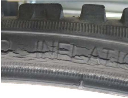
**Bild 1** Alterung: Rissbildung im Mantel eines Fahrradreifen
